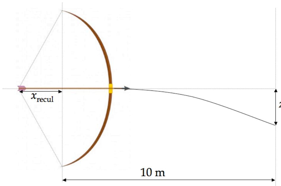
Lorsqu'un arc est bandé, la flèche a reculé d'une distance  $x_{\text{recul}}$  par rapport à sa position de repos. Le module de la force exercée par la corde sur la flèche est proportionnelle à la distance  $x$  :  $F = K x$ , où l'on suppose la constante de rappel égale à  $K = 200 \text{ N / m}$ .
