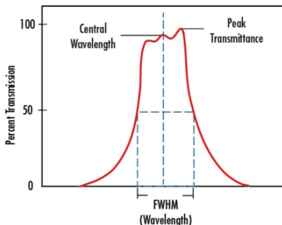
FIGURE: Transmission d'un filtre photométrique.
