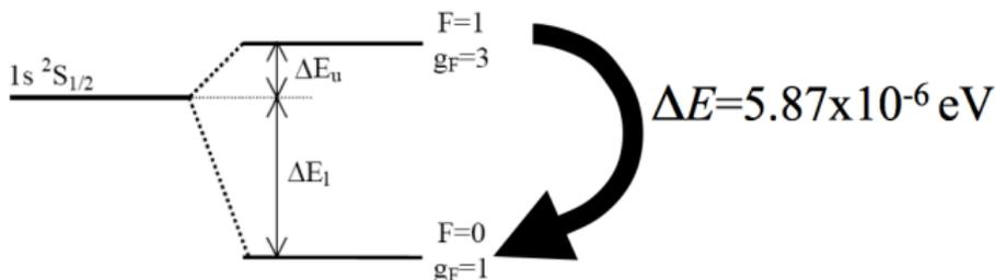
**FIGURE:** Séparation hyperfine du niveau fondamental ( $n = 1, l = 0$ ). Niveau hyperfin du haut : spin du noyau et spin de l'électron alignés (opposés dans le niveau hyperfin du bas). Ce splitting est présent à tous les niveaux  $n$ , et chaque état  $n$  possède donc une multiplicité  $2n^2$ .
