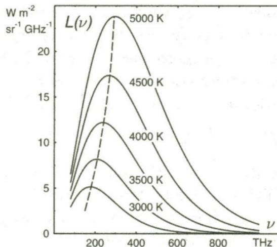
**FIGURE:** Distribution spectrale du rayonnement de corps noir en fonction de la fréquence  $\nu$ . La ligne en pointillé relie les positions des maxima de température.
