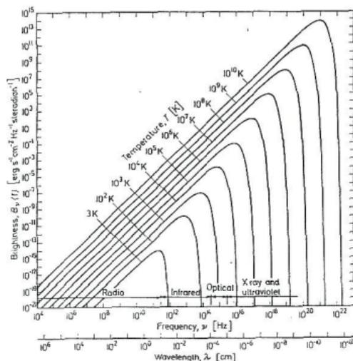
**FIGURE:** Distribution spectrale du rayonnement de corps noir pour différentes températures, en double échelle logarithmique. Remarquez l'absence d'intersection entre les différentes courbes.
