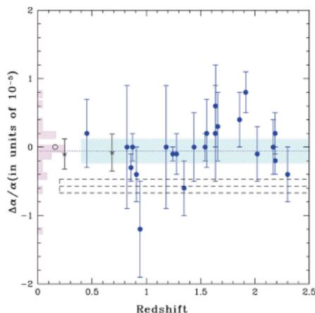
**FIGURE:** Mesures de la variation relative de  $\alpha$  en fonction du décalage spectral (redshift) et donc du temps inversé. Cercle = mesure provenant du réacteur naturel d'Oklo et les étoiles proviennent de spectres UVES (VLT) de quasars lointains impliquant des raies moléculaires. Traits interrompus = zone de variation de  $\alpha$  telle qu'annoncée par Murphy et al. (2003). Mesures UVES : incompatibles avec une telle variation de la constante de structure fine.
