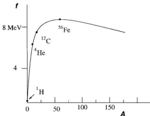
FIGURE: Schéma : énergie de liaison par nucléon.
