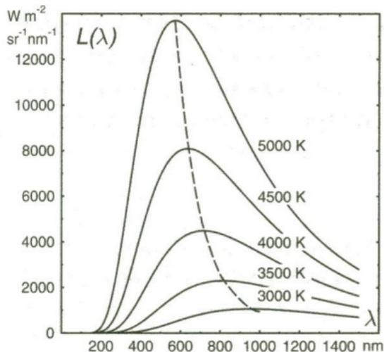
**FIGURE:** Distribution spectrale du rayonnement de corps noir en fonction de la longueur d'onde  $\lambda$ . La ligne en pointillé relie les positions des maxima de température.
