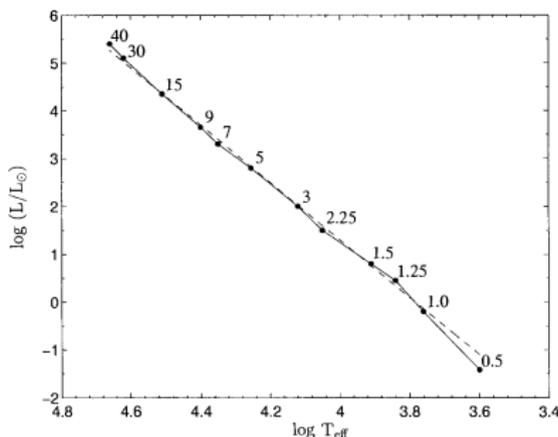
**FIGURE:** Diagramme HR (relation luminosité-température) obtenue à partir de modèles d'évolution stellaire (dans ce cas,  $L \propto T_{\text{eff}}^{5.6}$ ), et de l'Eq. 314 (pointillés). Les masses des modèles stellaires utilisés sont indiquées.
