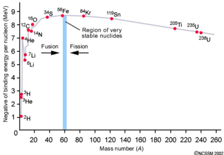
**FIGURE:** Energie de liaison par nucléon en fonction de la masse atomique. Les éléments du pic du fer ( $A \sim 56$ ) possèdent l'énergie de liaison par nucléon la plus élevée, 8.8 MeV ; par conséquent la fusion nucléaire de ces éléments en éléments plus lourds est endothermique.
