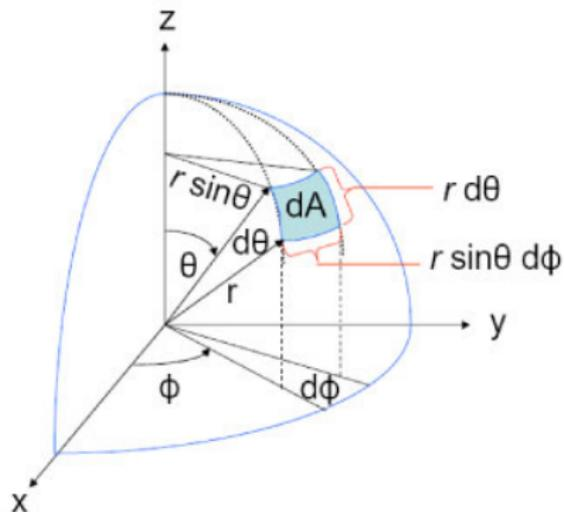
FIGURE: Surface élémentaire intersectée par l'angle solide  $d\Omega$  en coordonnées sphériques  $(\theta, \varphi)$
