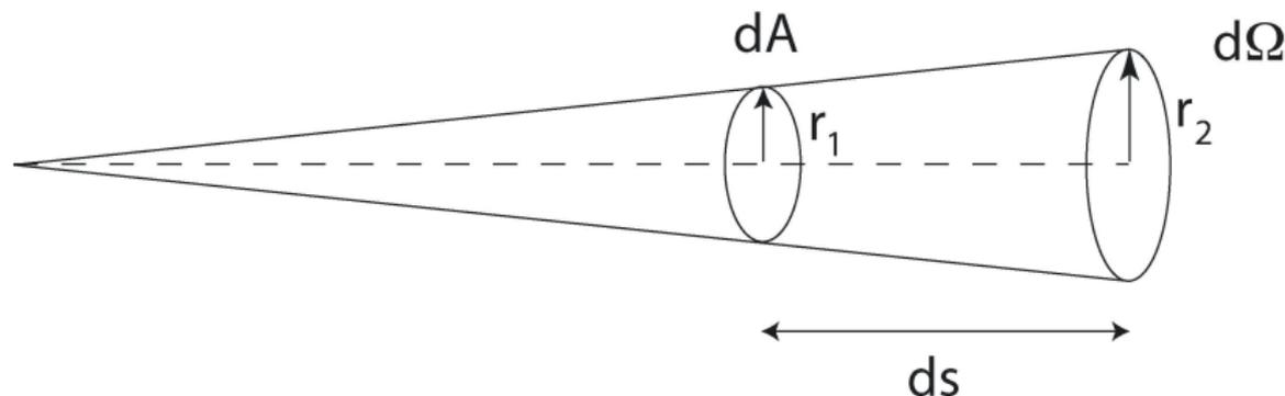
**FIGURE:** L'angle solide élémentaire tronqué est une portion de cône élémentaire qui peut être assimilée à un cylindre élémentaire
