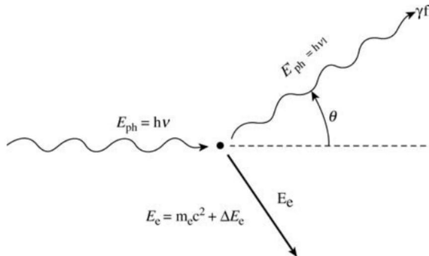
**FIGURE:** Schéma de la diffusion Compton avec un électron initialement au repos.
