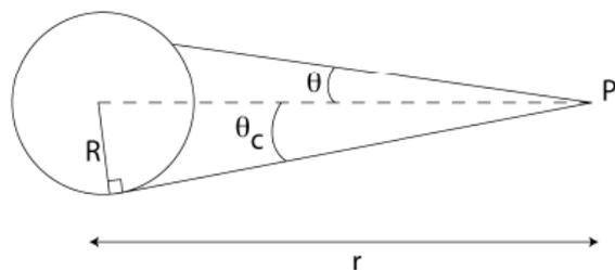
FIGURE: Flux émis par une sphère d'intensité uniforme B
