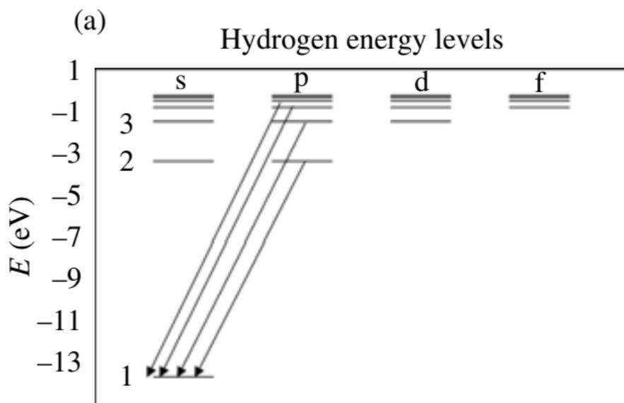
**FIGURE:** Diagramme simplifié représentant les niveaux d'énergie de l'hydrogène. Les transitions Lyman  $\alpha$  à  $\delta$  sont indiquées.
