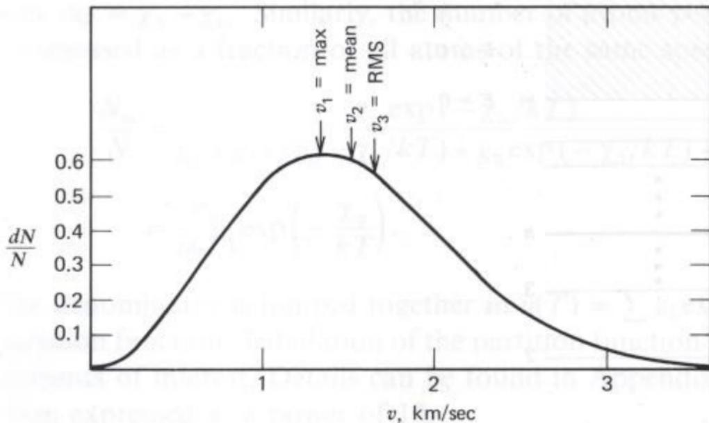
**FIGURE:** Distribution de Maxwell (Eq. 169) pour des atomes de fer à une température de 6000K. Les trois vitesses (plus probable = max, moyenne = mean, quadratique = RMS) sont indiquées.
