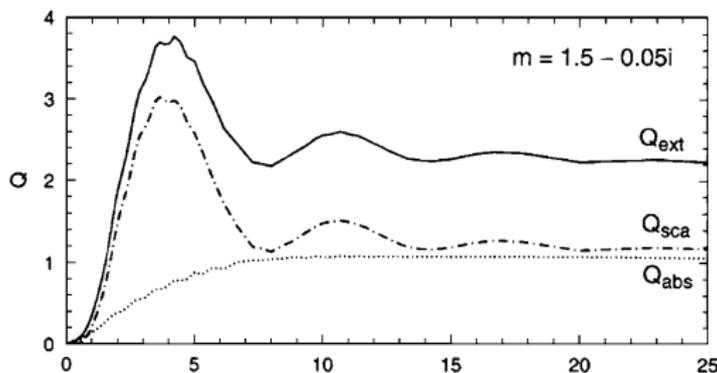
**FIGURE:** Efficacités d'extinction (ou absorption totale), de diffusion (scattering) et d'absorption pure (absorption) en fonction de  $x = 2\pi a/\lambda$ , pour un grain faiblement absorbant d'indice de réfraction  $m$ .
